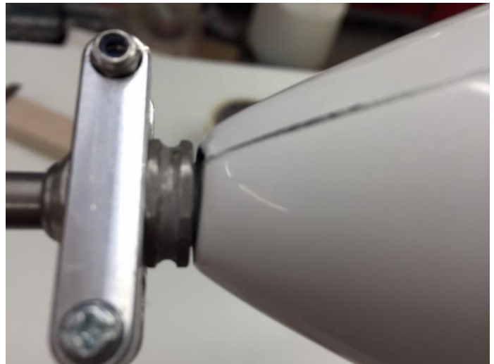
Eingesteckter Kugelrastbozen – Mutter darf nicht am Rumpf streifen !
