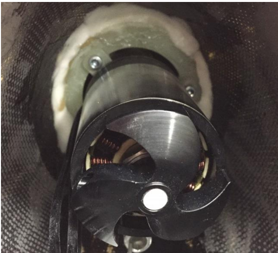
Vollständig eingeharzter Ringspant
